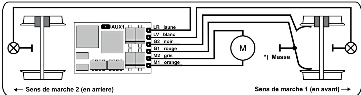
\*) Suivant les differents producteurs la masse peut etre connectee soit avec la roue 1 soit avec la roue 2
