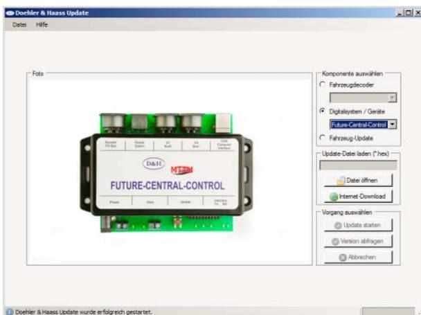
Nachdem die Datei geladen ist, wird durch Drücken der Update-Taste für ca. 1,5 Sekunden die FCC vom 'Normalbetrieb' in den 'Updatebetrieb' umgeschaltet. Der Update-Vorgang startet automatisch und dauert ca. 3 Sekunden.
