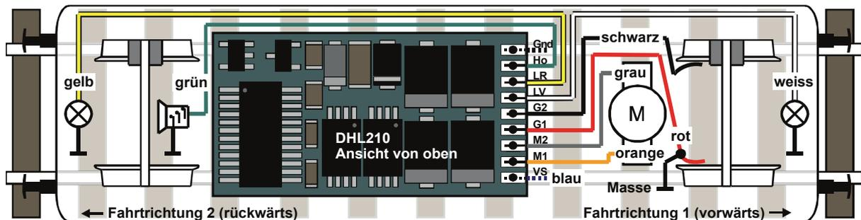
Der gemeinsame Rückleiter der Stirnlampen und ggf. der Zusatzfunktion (Horn) kann statt an Fahrzeugmasse an den Decoderausgang VS (= Versorgungsspannung) angeschlossen werden.
