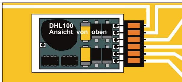
Beachten Sie bitte, daß die Anschlußdrähte gerade in die jeweiligen Kontakte eingeführt werden und keine Verbindung zu anderen Leiterbahnen entstehen.
